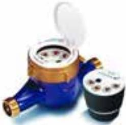
Nasslaufender Wasserzähler für Kaltwasser bis 50 °C. Montage - horizontale auch vertikale Stellung auf dem Fall- oder Steigrohr möglich. Durchflussmessgerät mit voll gekapseltem Zifferblatt. Hervorragende Messeigenschaften, Gerät der neuen Generation, Kontaktsensor für Fernablesungen.
