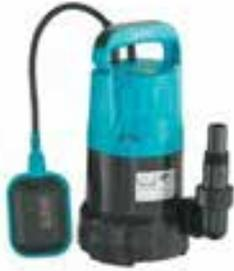
Drainagepumpe LEO der Reihe XKS- P ist eine Pumpe mit Gehäuse aus Kunststoff mit Ansaugung durch Schlitzsiebe, Schwimmerschalter und 10 m Kabel. Laufräder aus Noryl, Körnung der Festkörper max. 5 mm, Eintauchtiefe max. 7 m, 230V/50MHz. Zur Absaugung von leicht verschmutztem Wasser aus Brunnen, Schwimmbecken oder sonstigen Wasserflächen.
