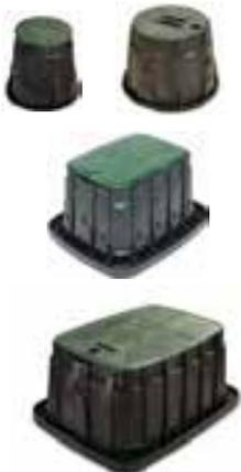
Ventilkästen RAIN BIRD: Typen 7" rund, 10" rund, STANDARD, JUMBO und MAXI JUMBO. Farbe: Kasten - schwarz, Deckel - grün. Material: recyceltes HD-PE Polyethylen. Öffnen: Sicherheitschraube ohne Griff und Scharnier. Vorgestanzte Stellen für Rohrdurchgänge. ANWENDUNG: In Bewässerungsanlagen, im Bauwesen.
